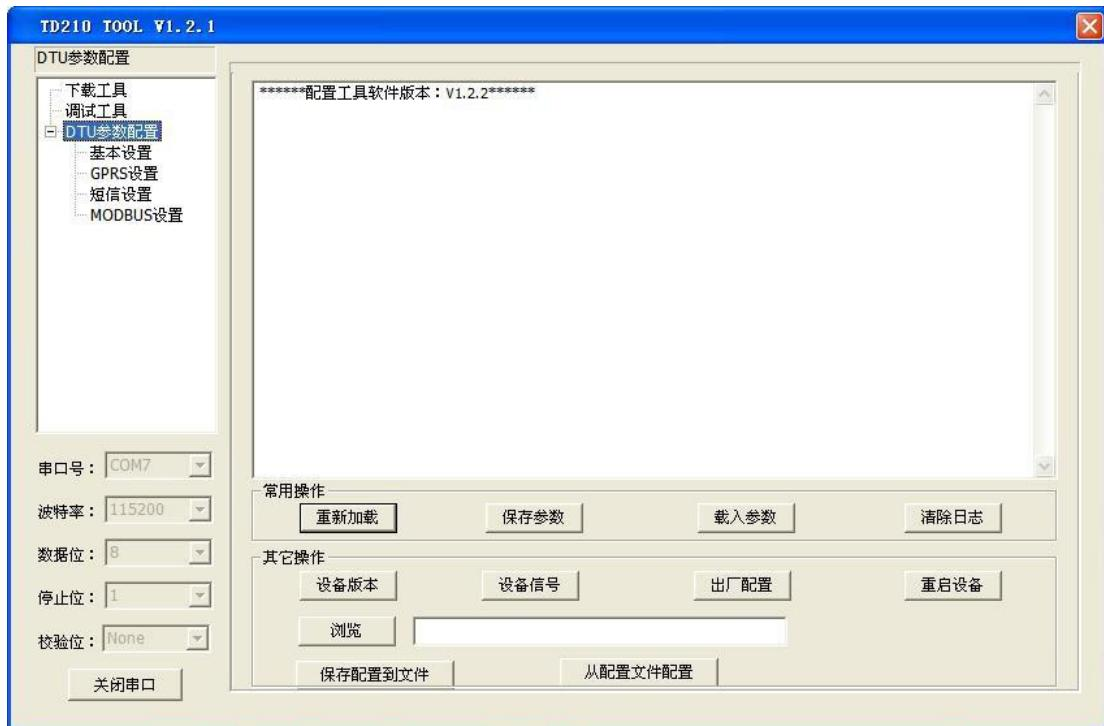
点击 **重新加载** 并重新上电 TD210 DTU，等待进入配置状态。
