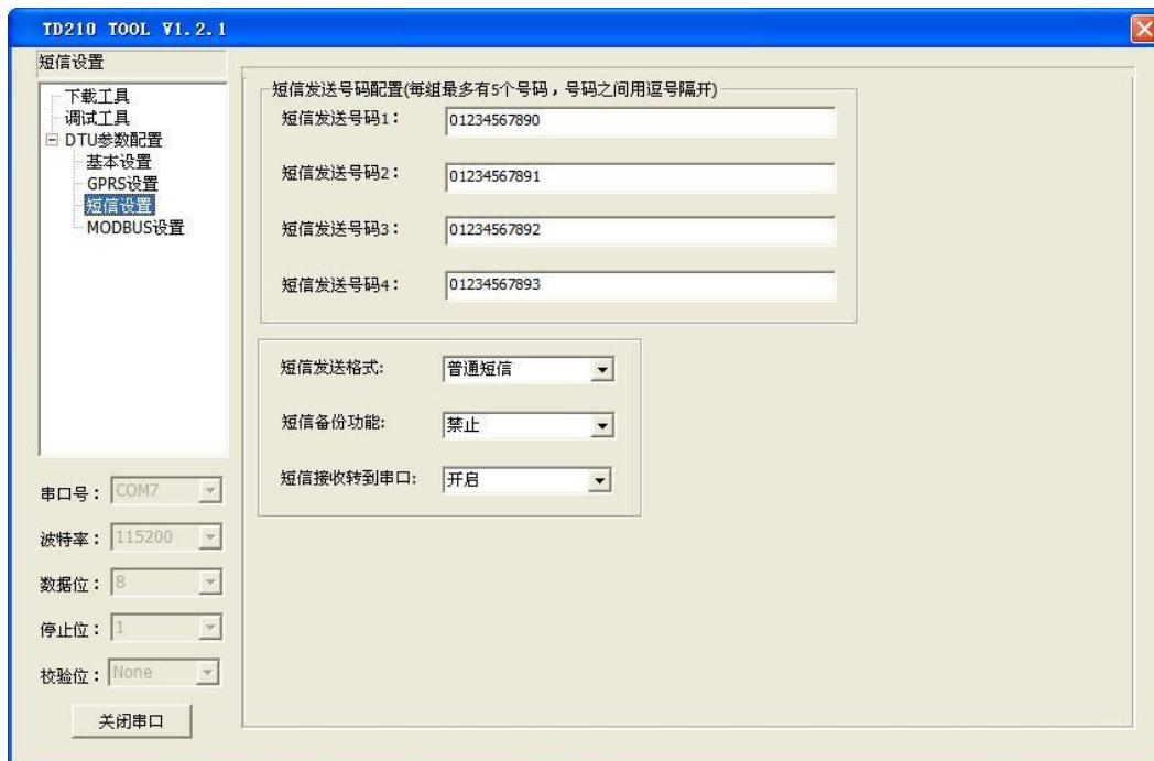
**短信发送号码:** 每组可以设置 5 个手机号码，各个手机号码用逗号隔开。每个手机号码的长度不超过 15 个数字。
